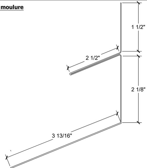
**Nom de la moulure:** Moulure jonction toit/mur
