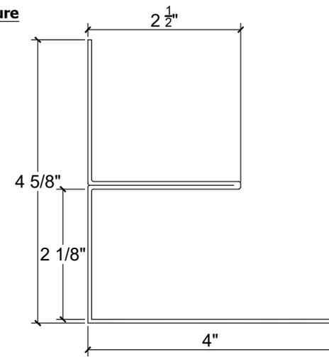
**Nom de la moulure:** Moulure jonction toit/mur
